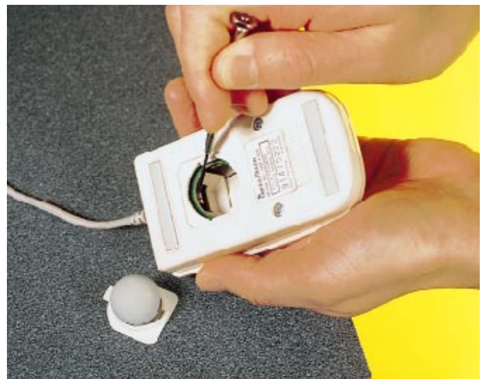
Удалить грязь с валиков можно с помощью небольшой отвертки или деревянной палочки
